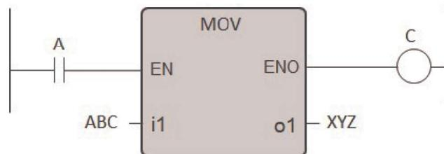
เมื่อ EN เป็น TRUE คำสั่ง Move จะสำเนาข้อมูลจาก Input ไปที่ Output
