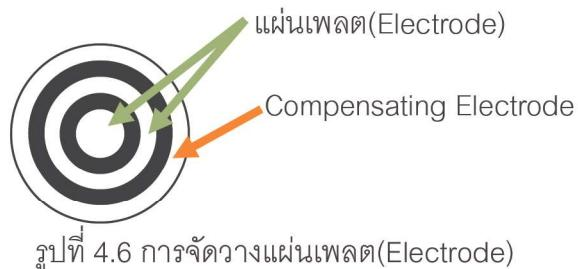
รูปที่ 4.6 การจัดวางแผ่นเพลต(Electrode)
